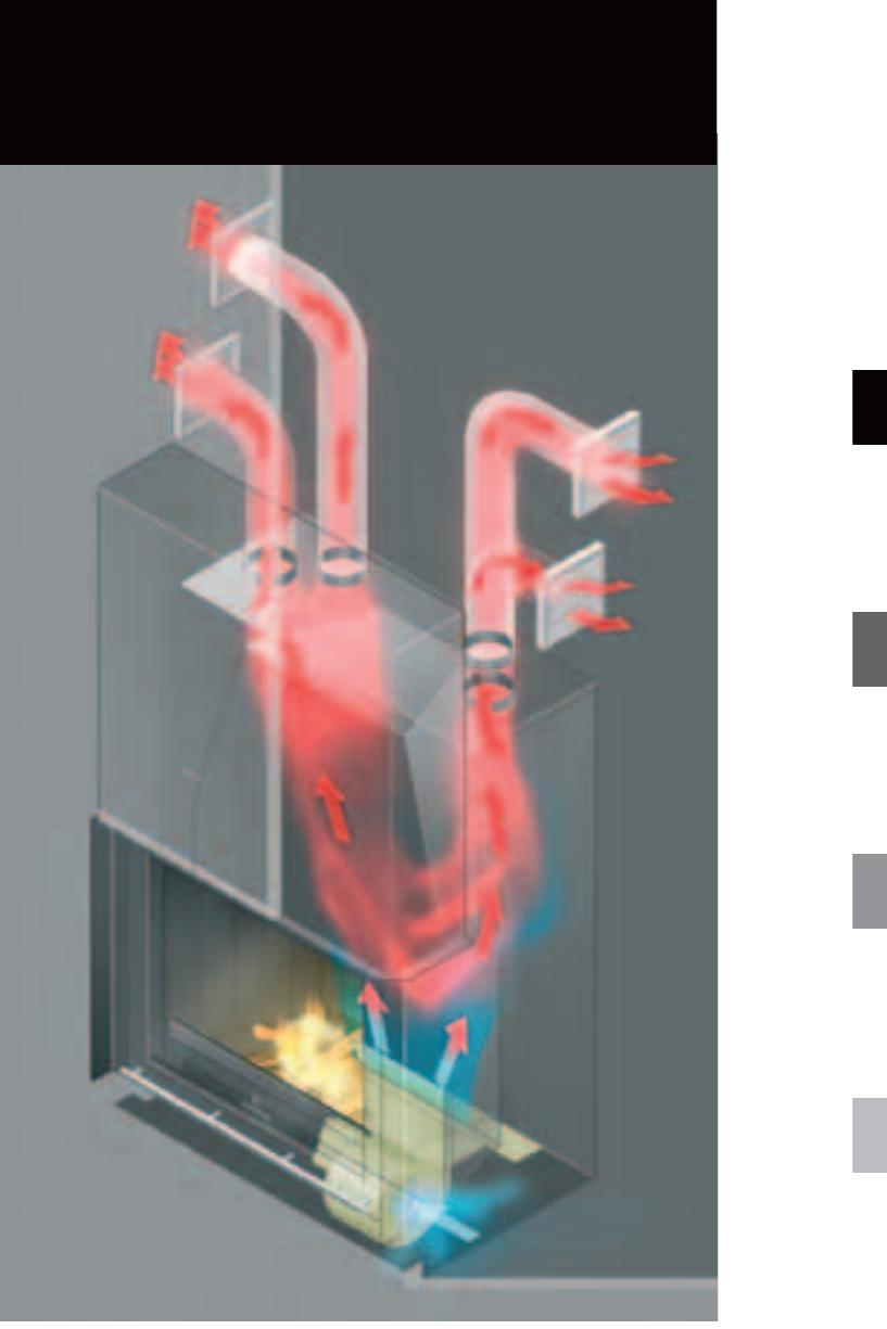
**NL** Elk model uit de Escamo-lijn heeft standaard een convectiemantel die de lucht verwarmt en gelijkmatig verspreidt over de te verwarmen ruimte. Het standaard convectionspakket dat bestaat uit luchtslangen en uitblaasroosters zorgt ervoor dat de verwarmde lucht de ruimte in gebracht wordt. De optionele Perma-air convectionventilator kan dit proces nog versnellen. U voelt daardoor een comfortabele warmte.
